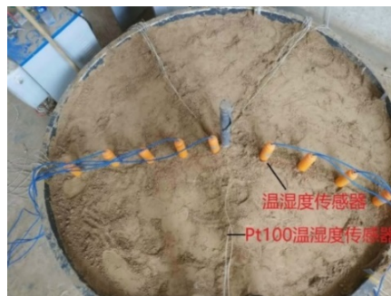
图 5 温湿度传感器平面布置图
